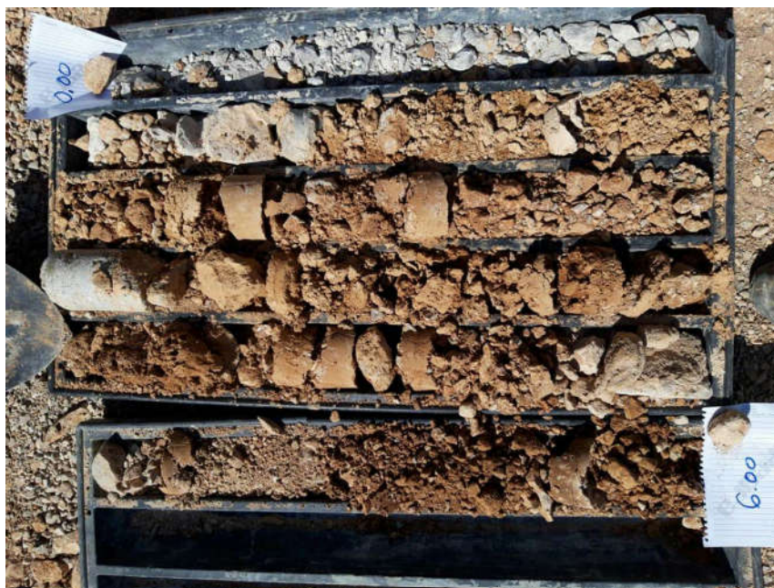
Slika 14. Bušotinski stup sidra izvedenog u neposrednoj blizini potpornog zida
